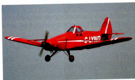
Exemple type d'un avion qui vole avec une allure queue haute : le fuselage est conçu pour donner une visibilité maximum au pilote et bien dégager le stab du sillage de l'aile... et des produits pulvérisés. L'incidence est portant tout à fait «normale».
